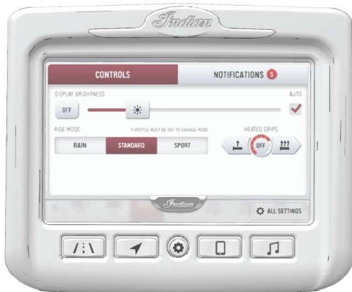
Desde el panel de control, puede acceder a las configuraciones, ajustar el brillo de la pantalla, seleccionar el modo de conducción y los controles de climatización del vehículo.
